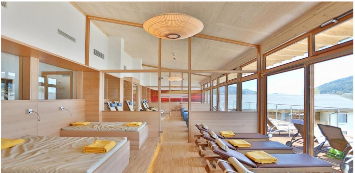
Abbildung 49: Ruheraum im „Wellnesspenthouse - Hotel SeeRose“ in reiner Holz- und Niedrig Bauweise – die gesamte Südfront wurde aufgeglast – das weitausladende Vordach schützt vor Überhitzung im Sommer
