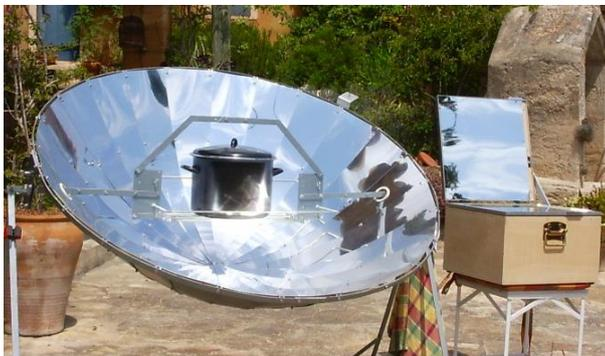
Abbildung 46: Ein Solarofen, wie er von verschiedenen Herstellern angeboten wird, könnte als Zusatzheizung und „Wasserverdampfer“ für eine Biosauna dienen.
